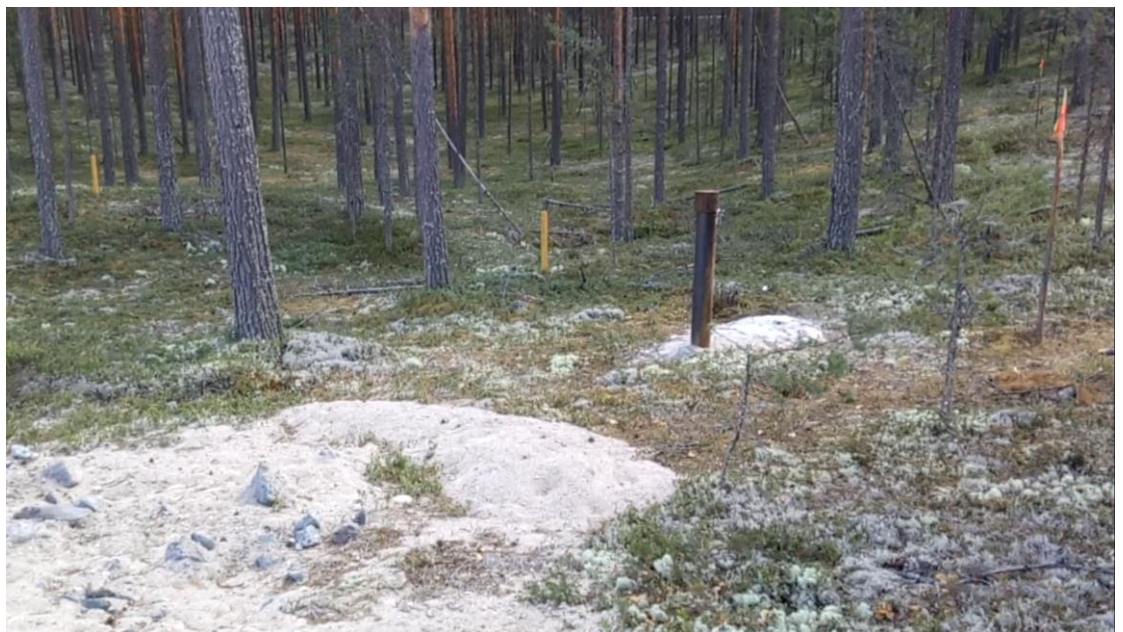
Kuva 11. Pohjavesiputki (tarkkailuputki) ottoalueen luoteisosalla.
